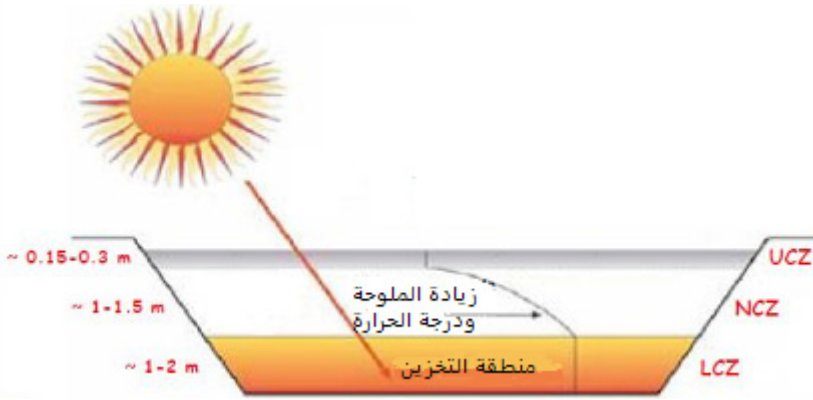
الشكل 13: رسم تخطيطي لحوض شمسي ذي تدرج ملوحة [36]
